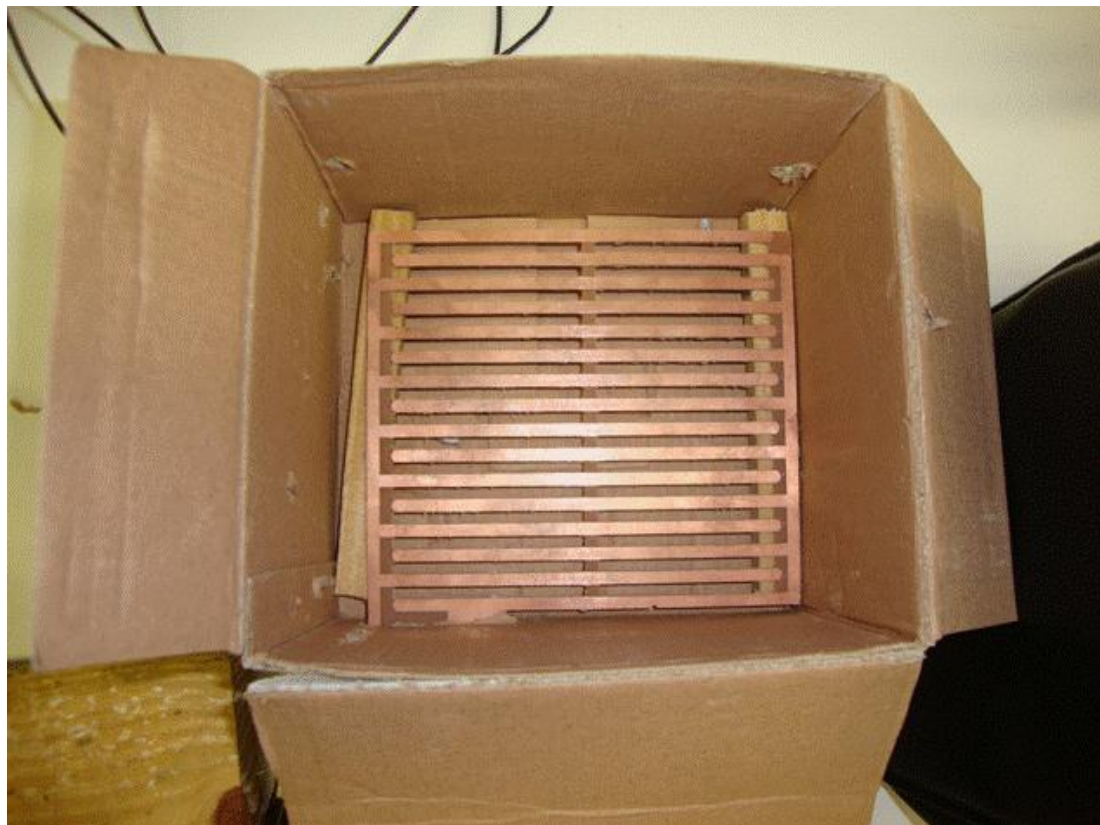
Figura 12 - Nova grade com espaçamento uniforme entre as trilhas.
