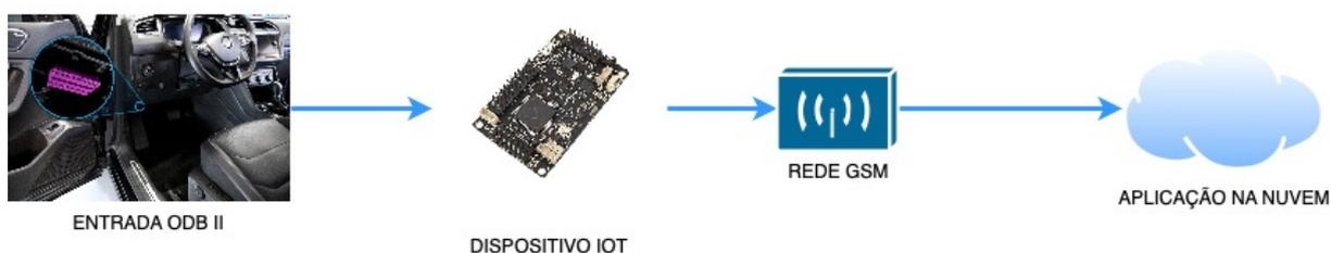
Figura 2 - Diagrama de comunicação do dispositivo com o software. Fonte: Autor
