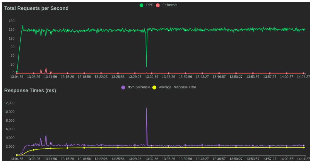
Figura 35 – Avaliação A17: W3 500 Usuários - C2 - Webservice (a) Requisições Totais por Segundo (b) Tempos Reposta por Milissegundo
