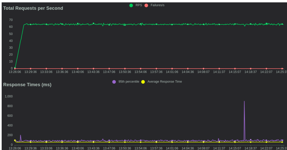
Figura 22 – Avaliação A04: W1 100 Usuários - C1 - Webservice (a) Requisições Totais por Segundo (b) Tempos Reposta por Milissegundo
