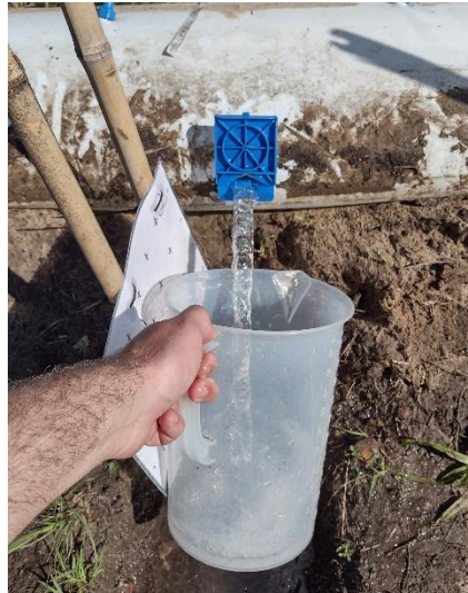
Figura 21: Medição da vazão real. O autor.
