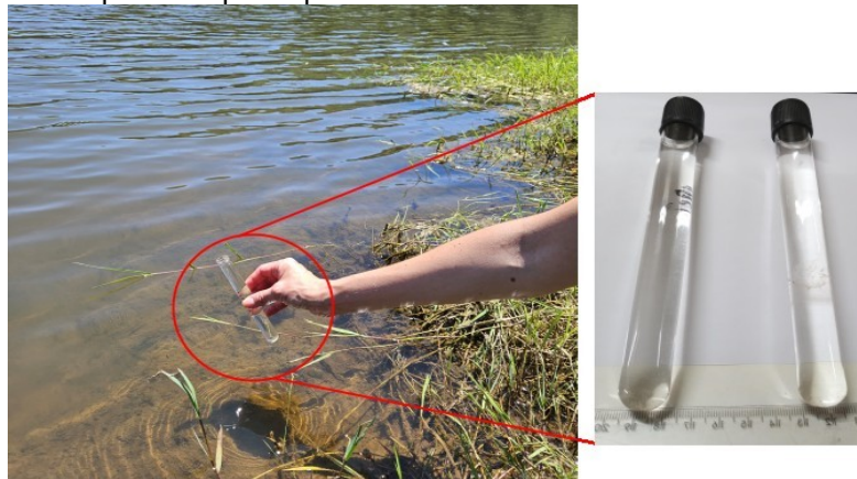
Figura 36 - Amostras d'água cristalina, turbidez 0 NTU, conforme dados do sensor de turbidez acoplado ao protótipo.
