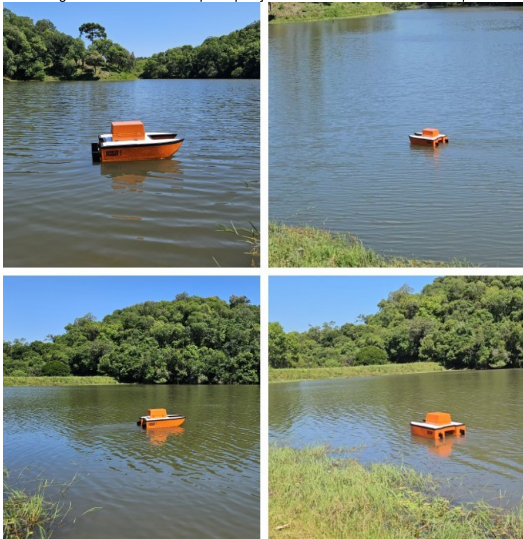
Figura 31 - Testes Protótipo: aquisição de dados ambientais em campo.
