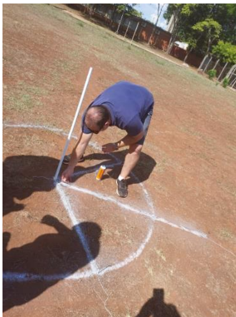
Figura 24 - Fotografia do passo 6: Determinação da linha que é perpendicular ( 90^\circ ) à linha norte-sul, isto é, determinação da linha leste-oeste
