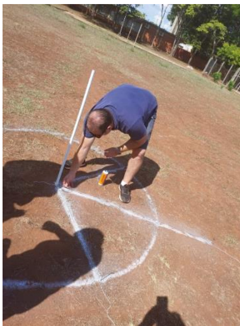
Figura 23 - Fotografia do passo 4 e 5: Acompanhamento e marcação do movimento da sombra e determinação da bissetriz
