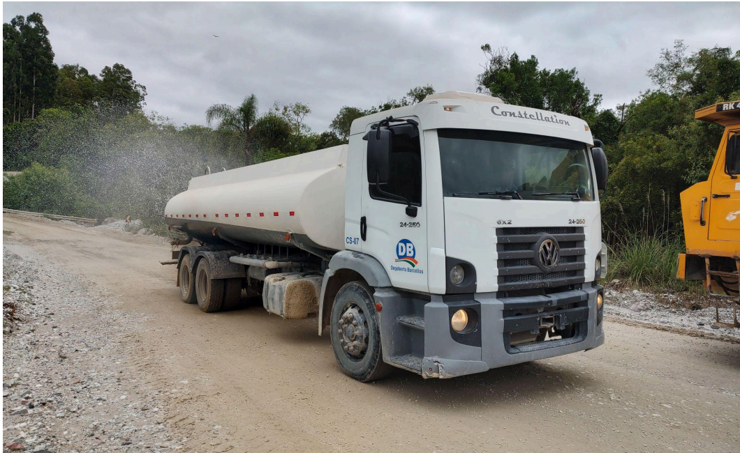
Figura 12 - Caminhão pipa para controle de emissões atmosféricas (Fonte: Autor, 2024).
