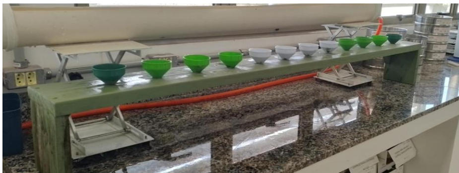
Figura 22 - Permeâmetro de carga constante utilizado para determinação da condutividade hidráulica saturada.
