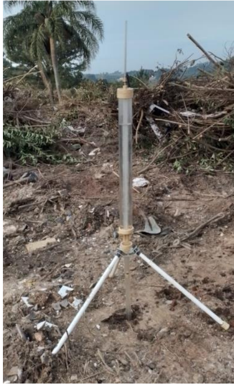
Figura 20: Permeâmetro de guelph instalado na área de estudo.
