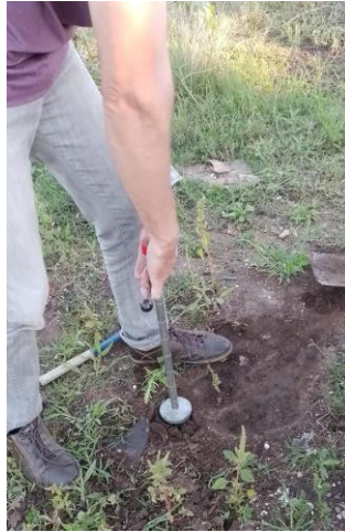
Figura 15 - Coleta de amostra indeformada com trado manual.
