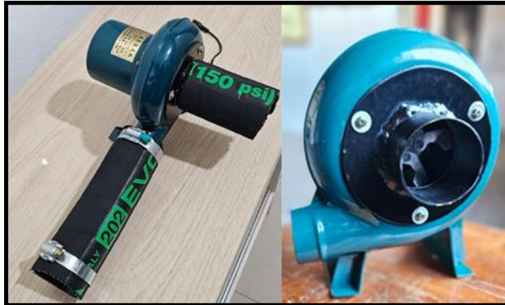
Figura 18. Ventilação de ar montada
