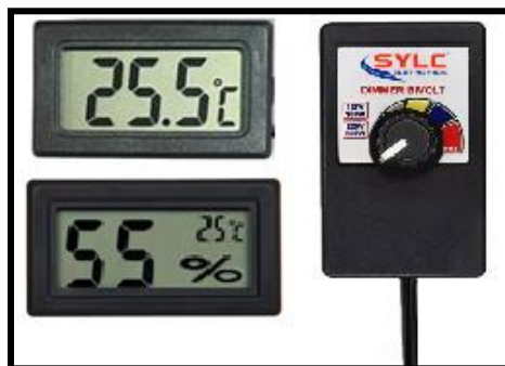
Figura 19. Controles de temperatura e velocidade de ar
