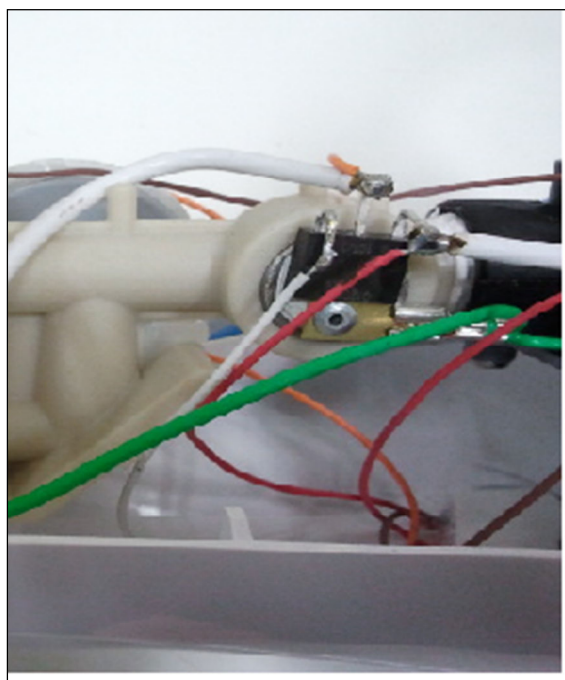
FIGURA 11 - TRIAC BTA41 colocado no dissipador.
