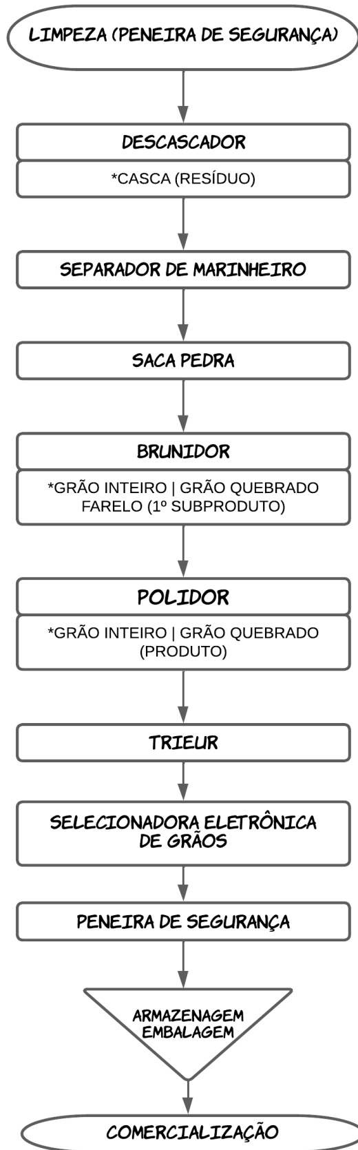
Figura 15 – Fluxograma dos procedimentos de beneficiamento do arroz
