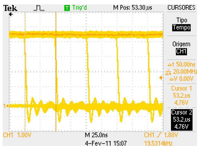
FIGURA 37 – Sinal de saída obtido a partir de 10 bits de resolução do PWM.
