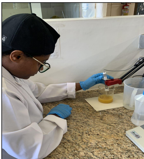
Figura 4: Verificação de íons de hidrogênio.
