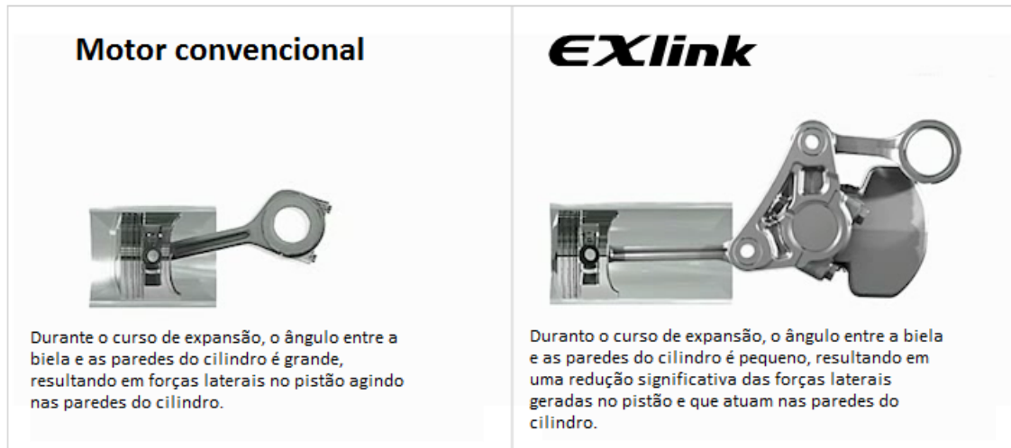
Figura 12 - Comparação da posição da biela para motores convencionais e EXlink.
