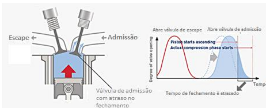
Figura 5 - Tempo em função do ângulo de abertura das válvulas.
