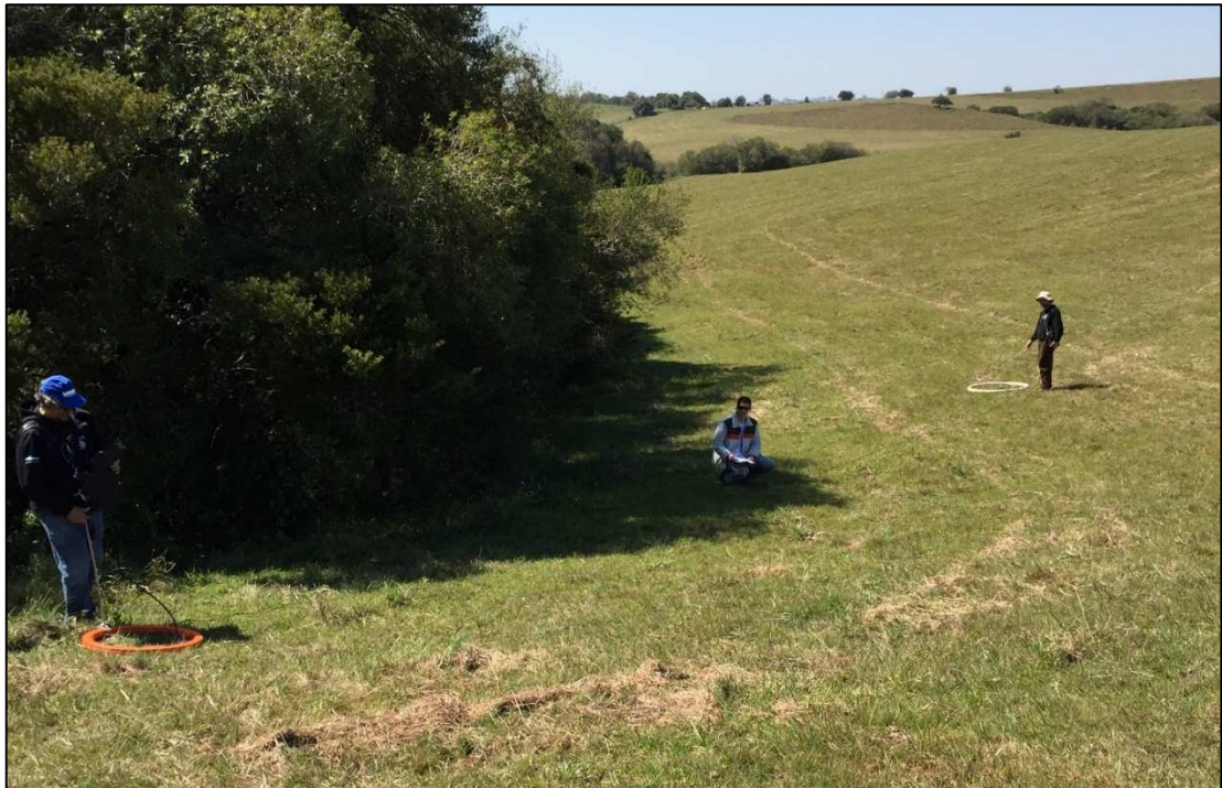
Figura 19 - Foto da aplicação do método eletromagnético com o equipamento EM-34XL geocondutivímetro da Geonics utilizado em campo.
