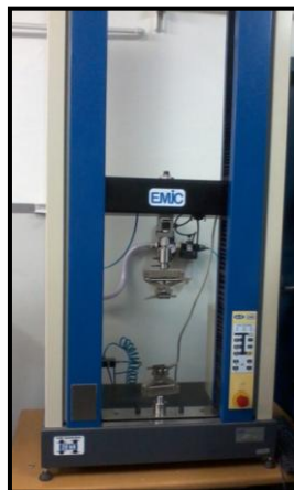
Figura 3. 5 – Máquina de ensaios Emic DL-2000
