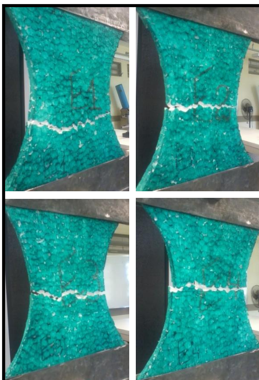
Figura AP-A. 3 - Configuração das trincas resultantes dos ensaios de tração com os corpos de prova tipo E
