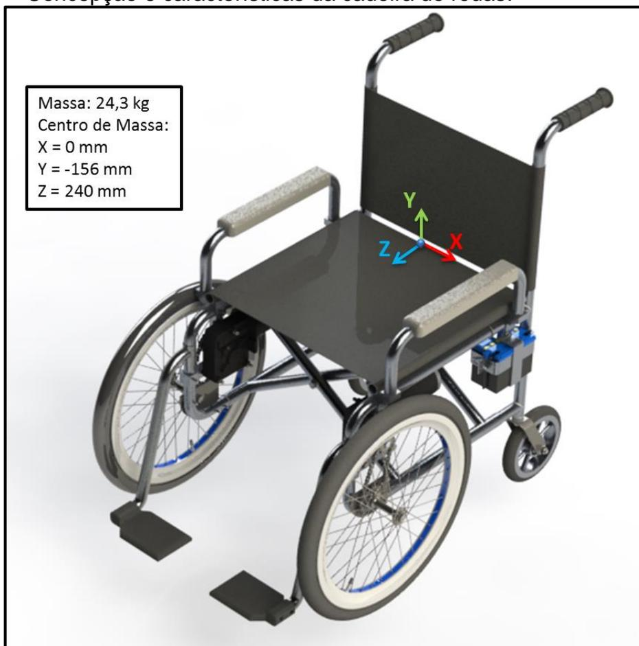
Partindo da concepção criada, pode-se definir os sistemas, subsistemas e componentes (SSCs) que compõem a cadeira de rodas como indicado pela Figura 26.
