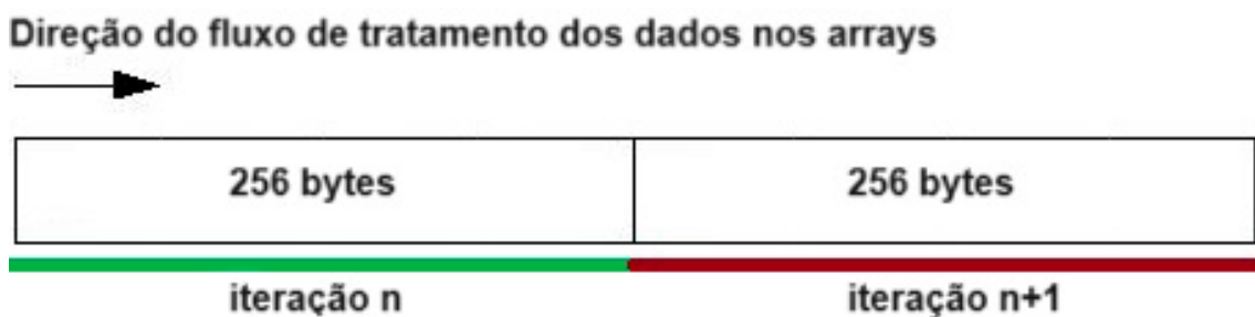
Figura 20 – Representação conceitual da estratégia de prefetching utilizada, buscando disponibilizar na cache os dados dos arrays trabalhados, durante as iterações de has_new_bits() .
