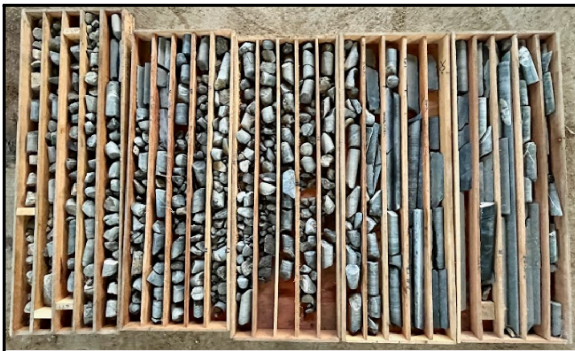
Figura 13: Caixas de testemunhos do Furo-05.
