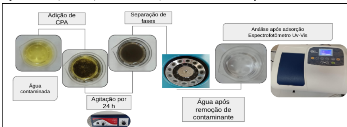
Figura 12. Esquema representativo do procedimento de adsorção em batelada
