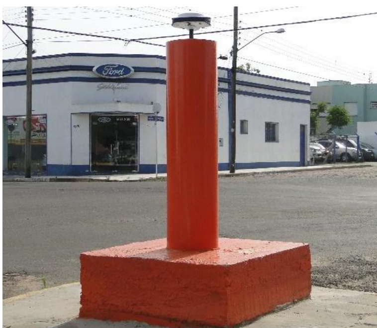
Figura 1 Rastreo GNSS num dos vértices da linha base do projeto GeoItaqui
