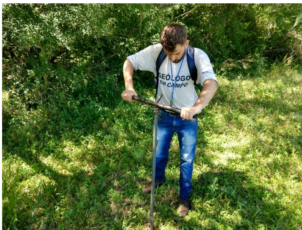
Figura 21 – Realização de amostragem de solo com trado manual.
