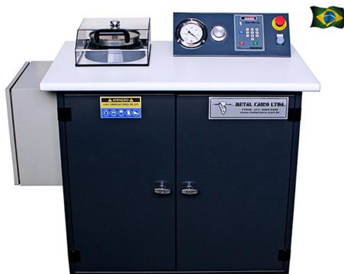
Figura 8 – Equipamento utilizado para o ensaio da finura do cimento - Peneirador Aerodinâmico PVE-I
