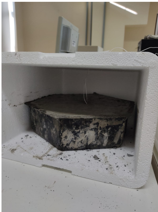
Figura 12 – Estrutura para o ensaio de liberação de calor de hidratação.
