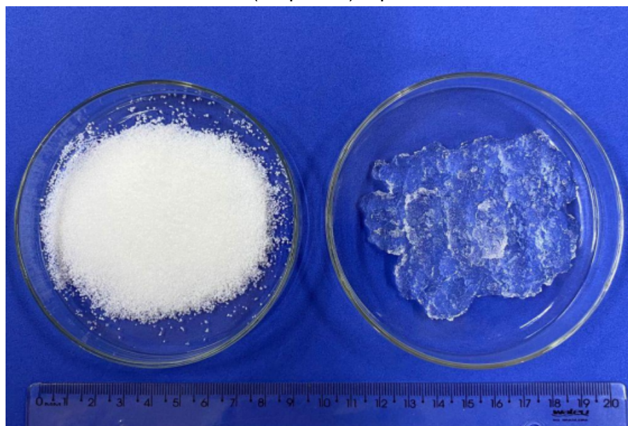
Figura 7 – Polímero no estado seco (esquerda) e polímero no estado saturado (direita).
