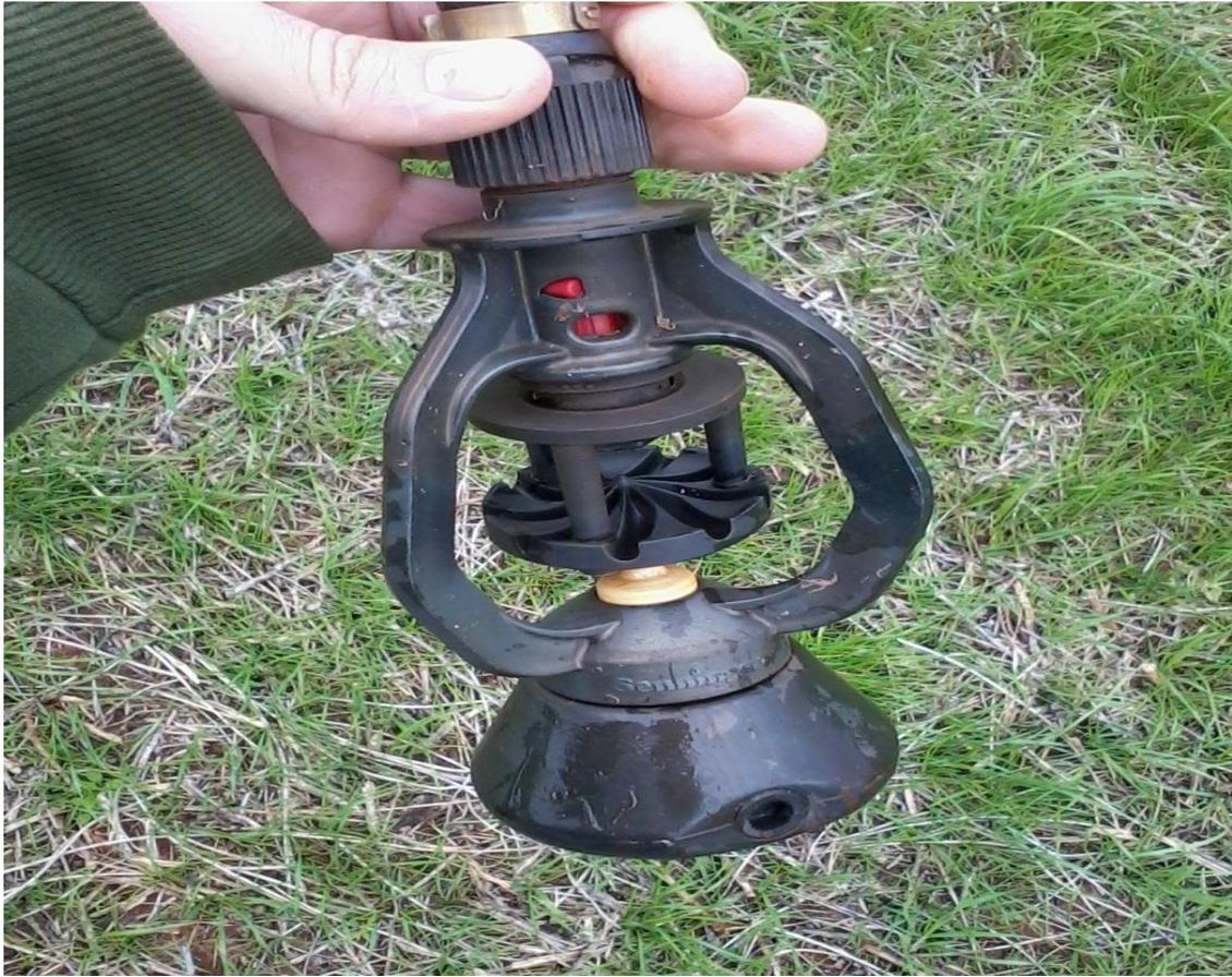
**Figura 04** – Aspersor instalado no pivô, modelo i-Wob Wobbler da Senninger. Fonte: Hohenberger, L. (2016).
