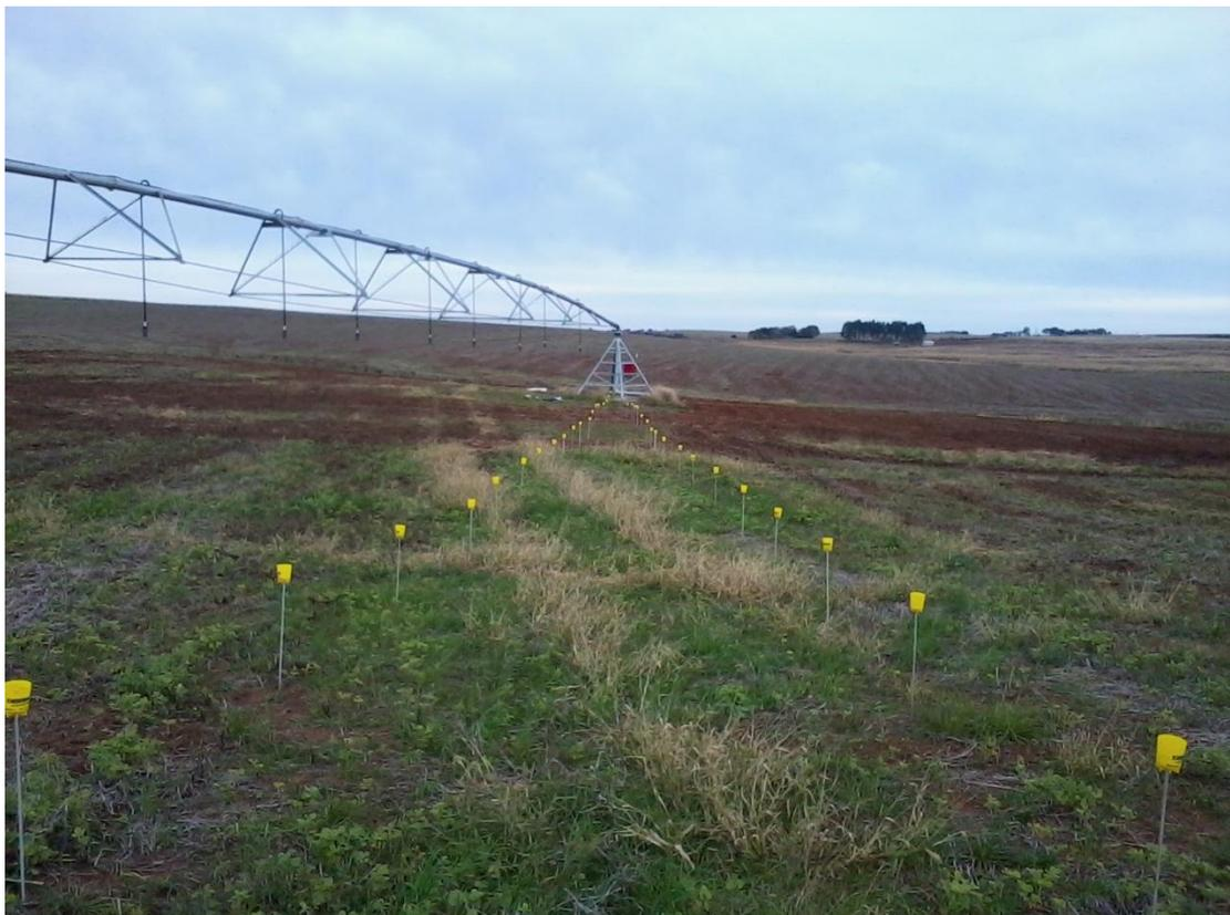
**Figura 02** – Posicionamento dos coletores com angulação. Fonte: Hohenberger, L. (2016).
