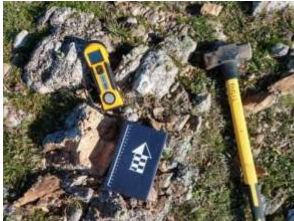
Figura 19 – Susceptibilímetro Kappameter modelo KT-10 utilizado para a obtenção dos valores de susceptibilidade magnética em um afloramento de rocha metamórfica na área de estudo.
