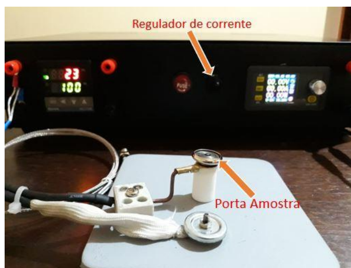
Figura 13 - Dispositivo de temperatura.
