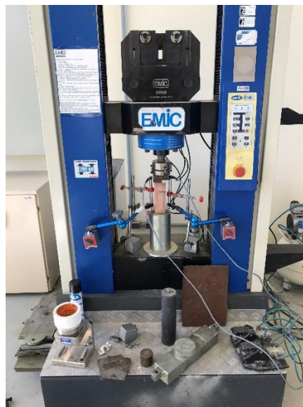
Figura 17 – Ensaio compressão paralela as fibras.
