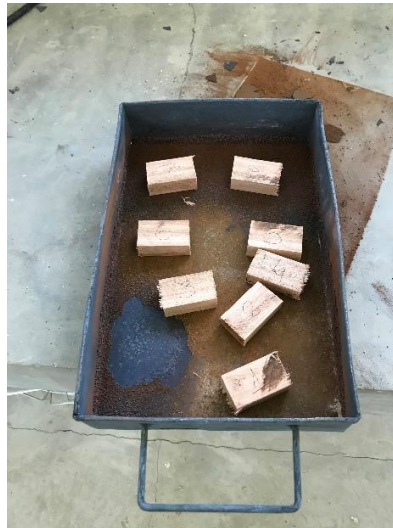
Figura 13 – Corpos de prova para ensaio de umidade.
