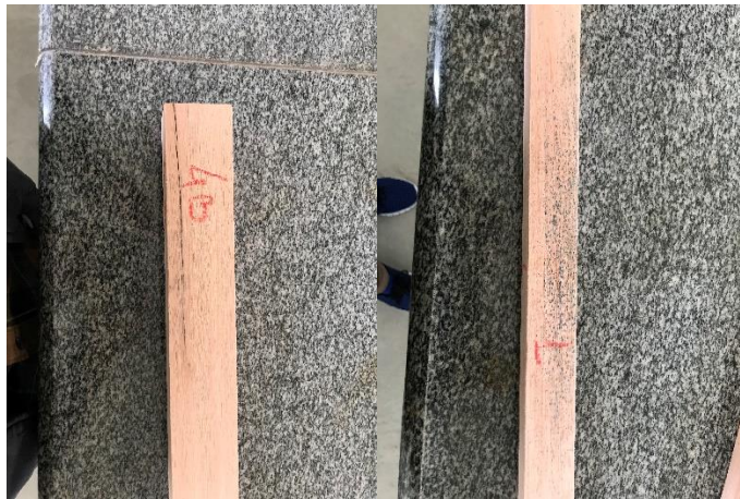
Figura 21 – Identificação de defeitos nos corpos de prova.
