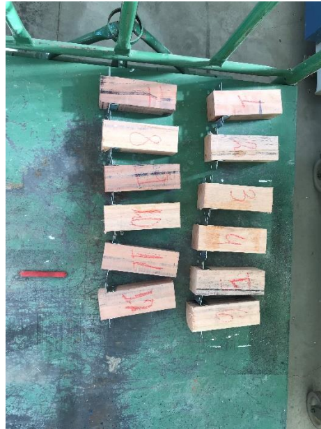
Figura 16 – Corpos de prova para ensaio de compressão paralela as fibras.
