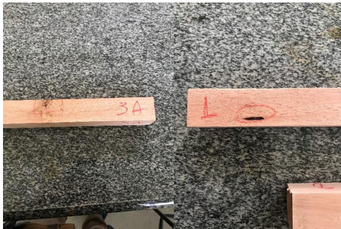
Figura 20 – Identificação de defeitos nos corpos de prova.
