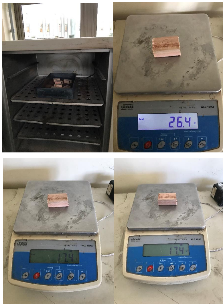
Figura 14 - Processo de secagem e pesagem.
