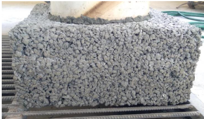
Figura 15 – Fixação do anel de infiltração plástico.
