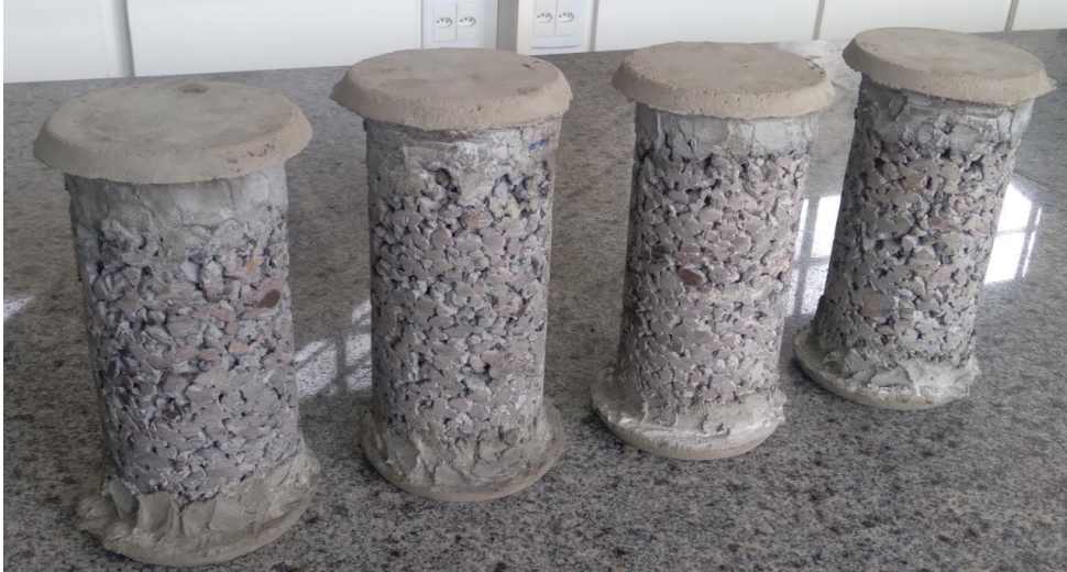
Figura 19 – Capeamento dos corpos de prova para teste de compressão axial.
