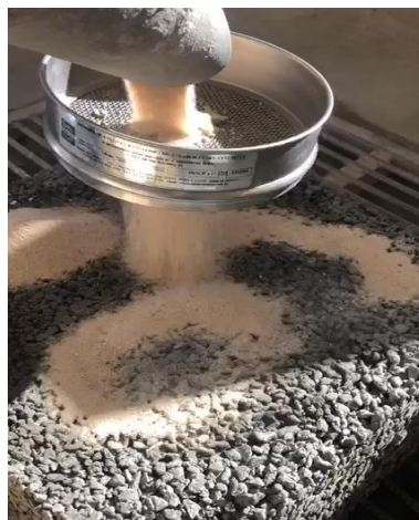
Figura 13 – Adição de areia na placa para entupimento induzido.
