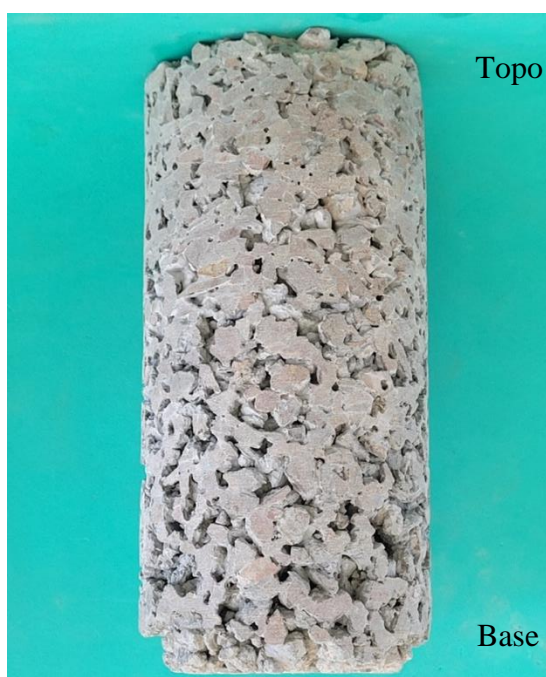
(c) perfil da distribuição vertical da porosidade do corpo de prova
