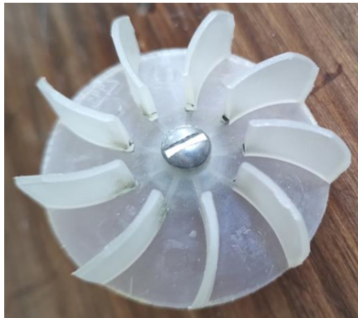
Figura 14. Rotor utilizado para o sistema de aeração.
