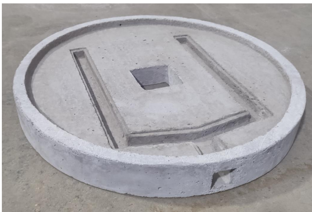
Figura 11. Base do silo aerador em concreto, desenformada.
