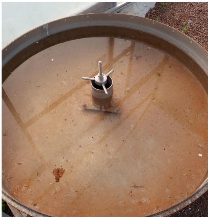
**Figura 10 - Tanque Classe A**
