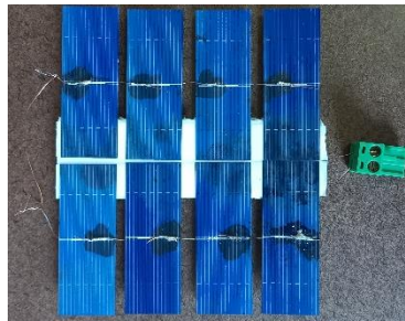
Figura 82 - Estrutura com oito células solares em série
