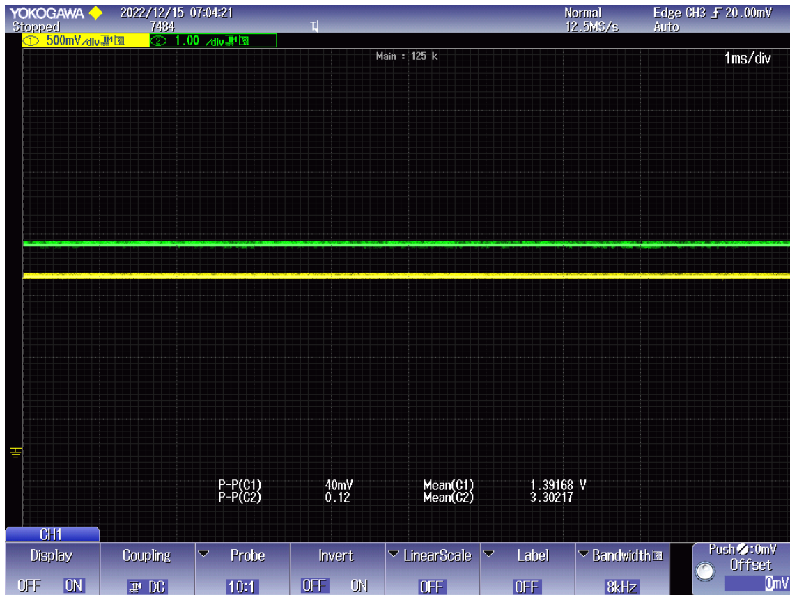
Figura 65 - Valores de funcionamento, com carga 58,3 Ω, do conversor TPS61200
