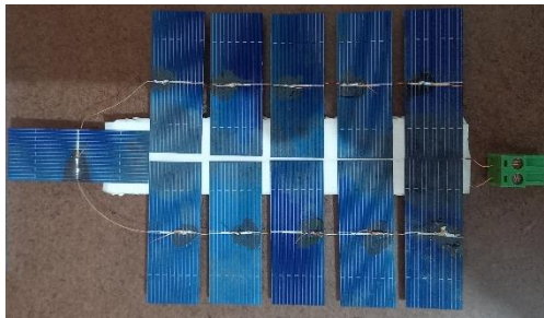
Figura 80 - Estrutura com onze células solares em série
