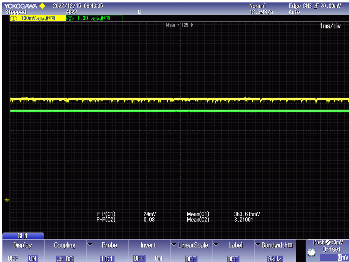
Figura 64 - Valores de funcionamento, sem carga, do conversor TPS61200
