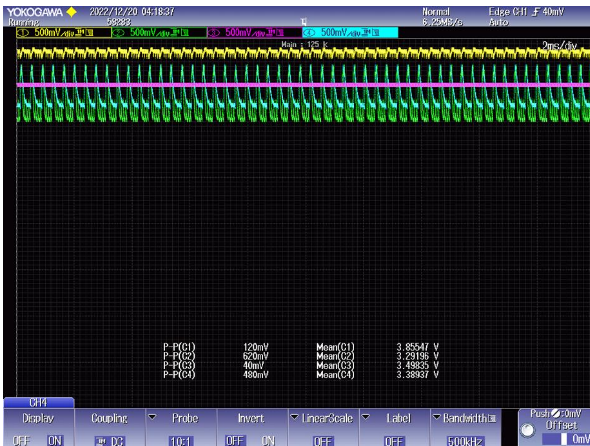
Figura 50 - Valores de funcionamento com carga de 48,3 \Omega , 18 k \Omega e 220 \Omega de três conversores TPS61097A
