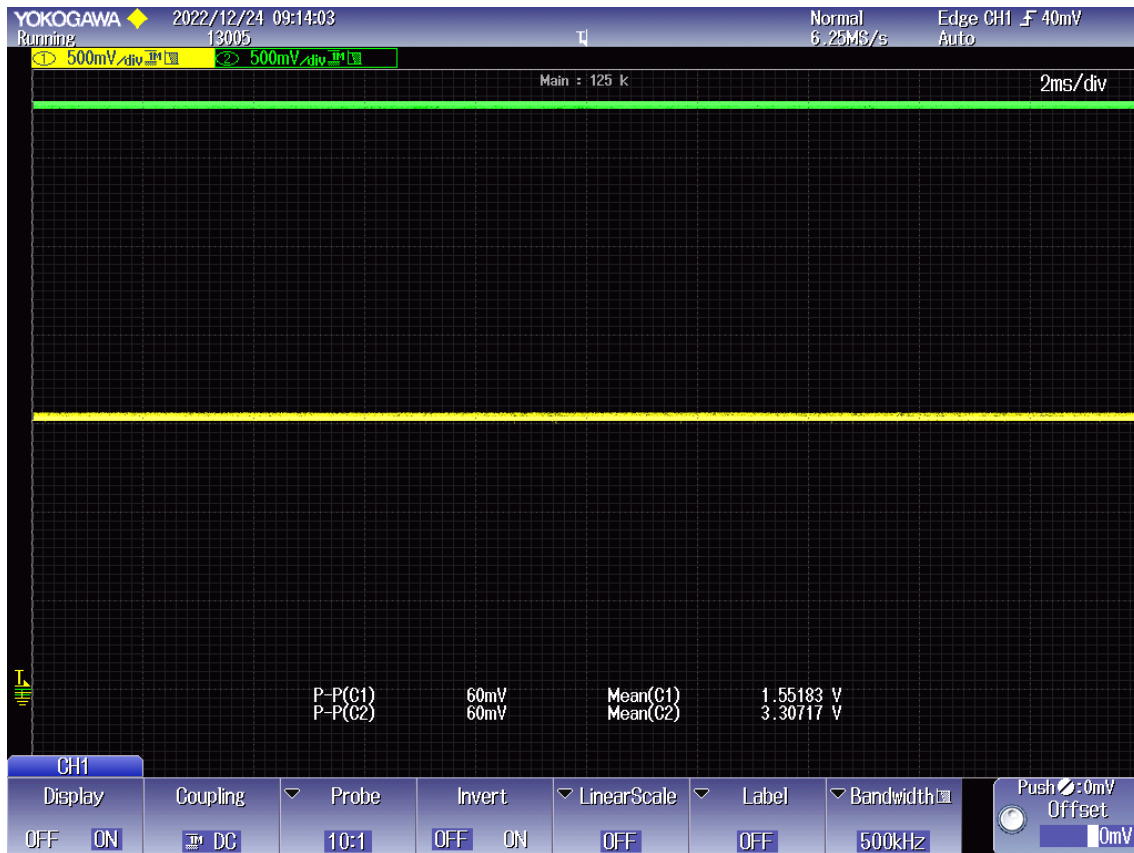
Figura 69 - Valores de funcionamento, com carga de 36,3 \Omega , do conversor TPS61097A
