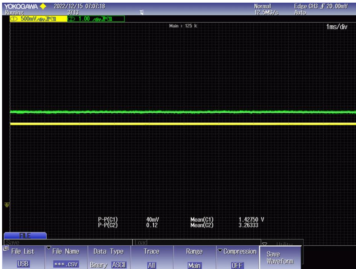
Figura 66 - Valores de funcionamento, com carga 36,3 \Omega , do conversor TPS61200
