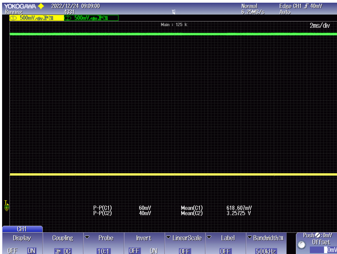
Figura 68 - Valores de funcionamento, sem carga, do conversor TPS61097A
