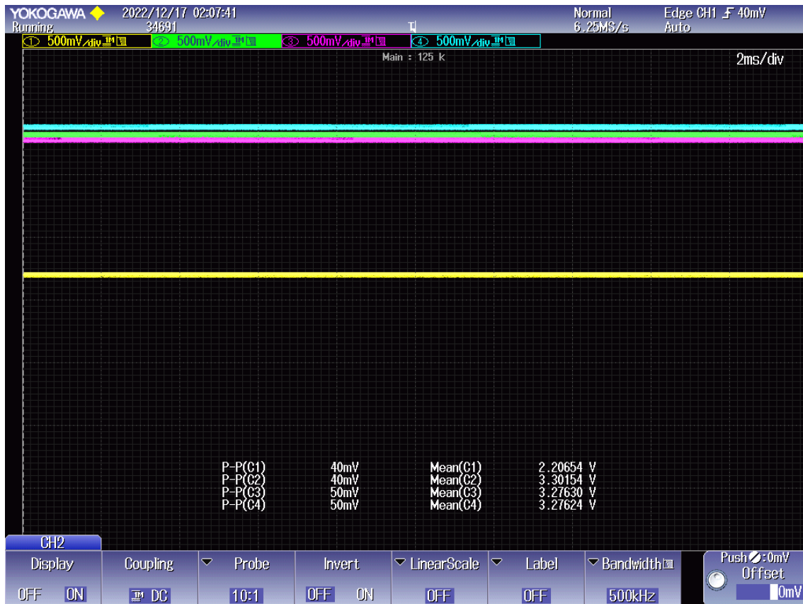
Figura 47 - Valores de funcionamento sem carga de três conversores TPS61097A
