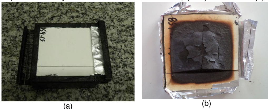
Figura 49 - Amostra de piso melamínico de alta pressão no ensaio de determinação óptica da fumaça sem chama antes do ensaio (a) e após o ensaio (b).
