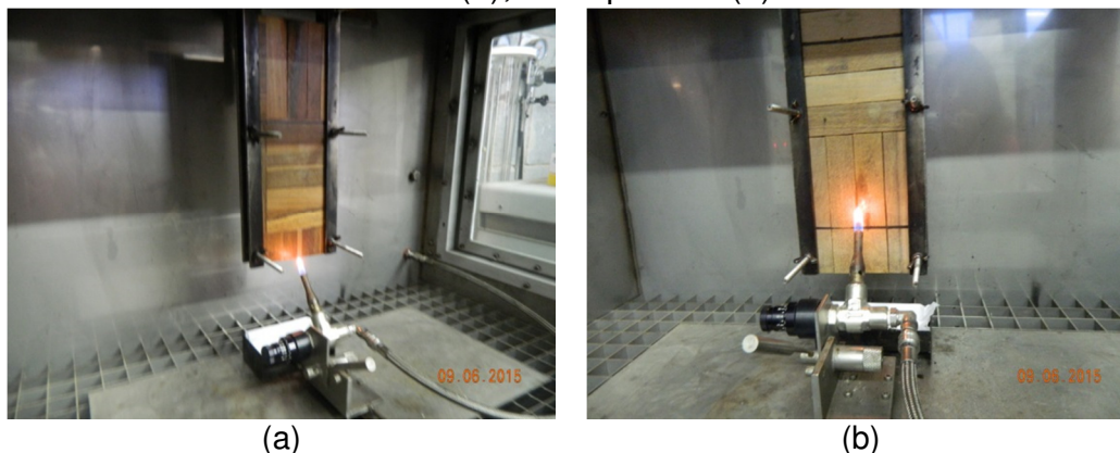
Figura 42 - Amostra do piso de madeira em parquet no ensaio de ignitabilidade: de borda (a); de superfície (b).
