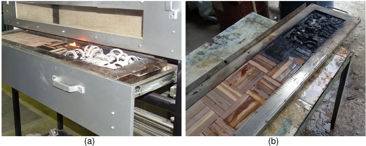
Figura 41 - Ensaio de reação ao fogo: piso de madeira em parquet após ensaio (a); após resfriamento (b)
