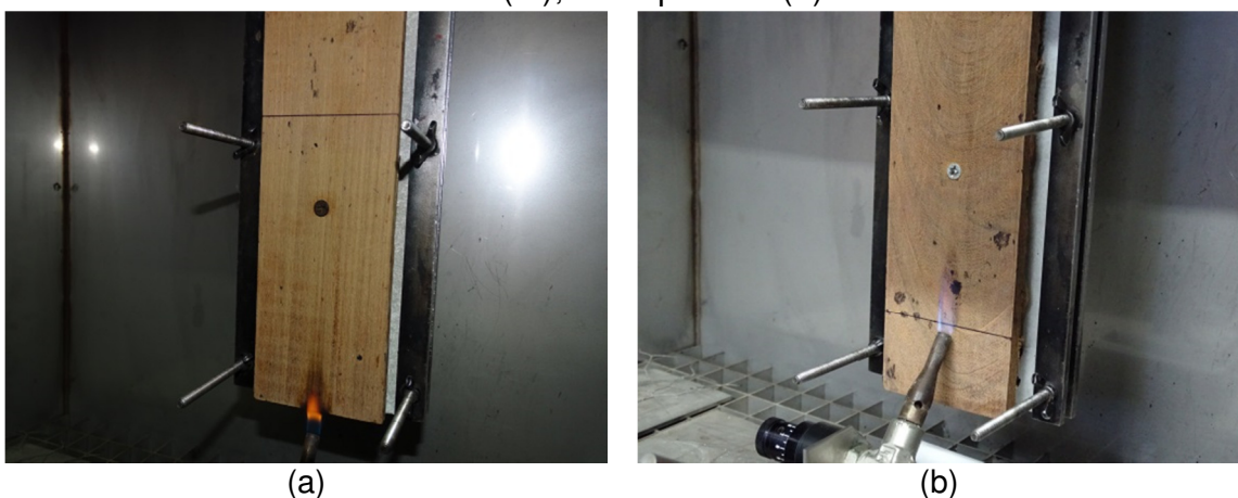
Figura 34 - Amostras do piso de madeira em taco no ensaio de ignitabilidade: de borda( a); de superfície (b).
