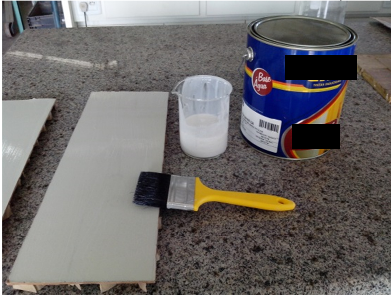
Figura 24 - Pintura com verniz antichama MARCA A (base água).
