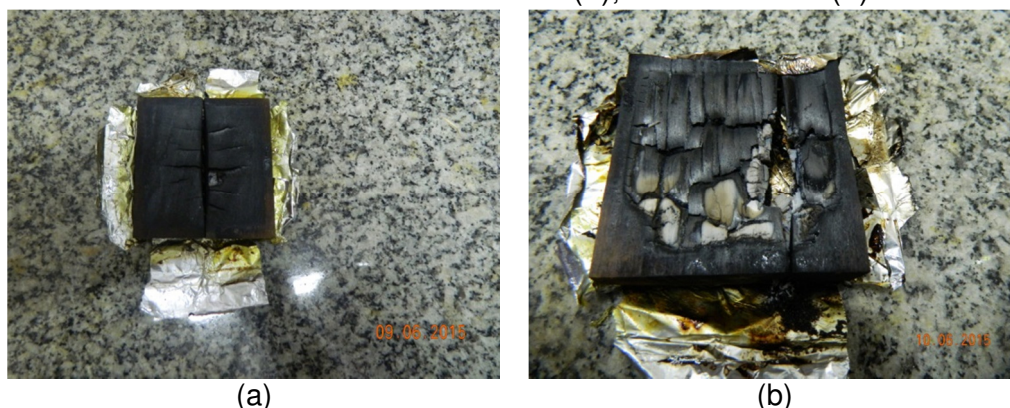
Figura 38 - Ensaio de determinação da densidade óptica da fumaça do piso de madeira em taco sem chama (a), e com chama (b).
