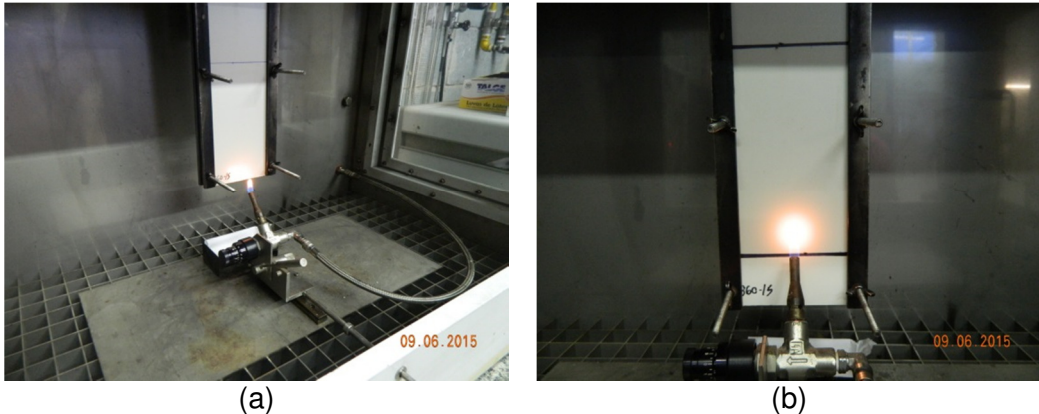
Figura 47 - Amostra de piso melamínico de alta pressão no ensaio de ignitabilidade com aplicação do queimador na borda (a) e na superfície(b).
