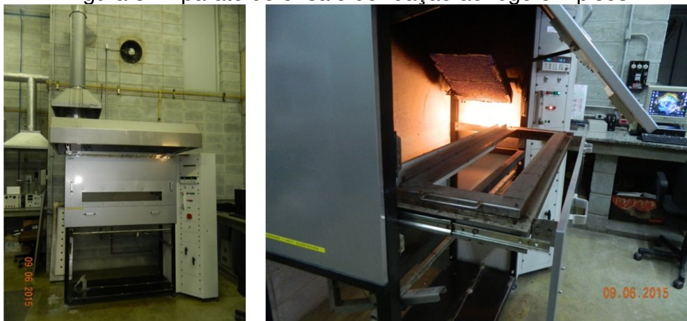
Figura 3 - Aparato de ensaio de reação ao fogo em pisos.
