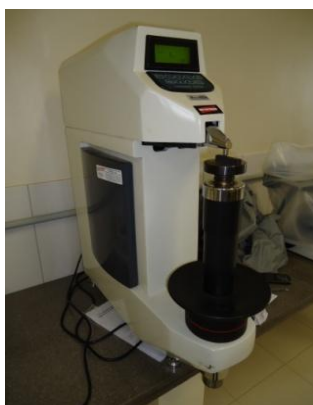
Figura 24 – Visão geral do Durômetro utilizado na pesquisa
