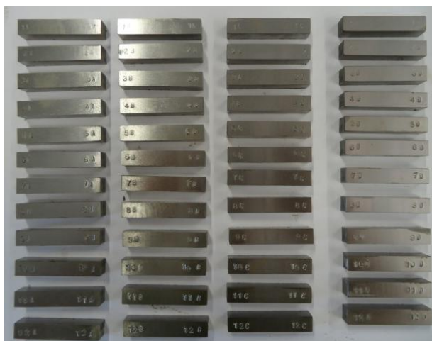
Figura 22 - Conjunto de amostras usinadas e marcadas
