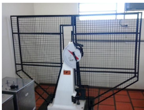
Figura 27 - Máquina de Ensaio Charpy RMU Testing
