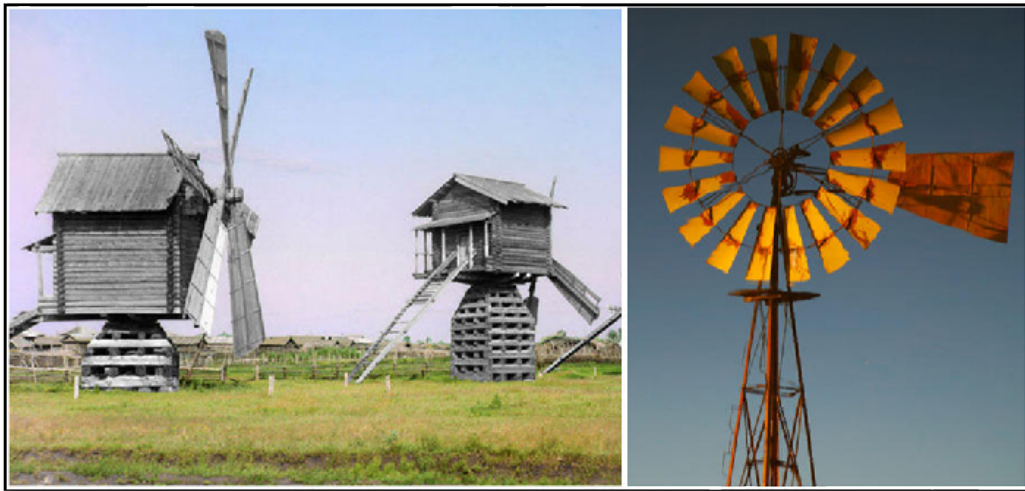
Figura 5- À Esquerda, Foto de Moinhos no Verão Siberiano de 1912, (Prokudin-Gorski, 1912). À Direita, Cata-Vento Utilizado para Bombeamento de Água no Brasil e seu Dispositivo de Segurança, Pá à Direita do Rotor.
