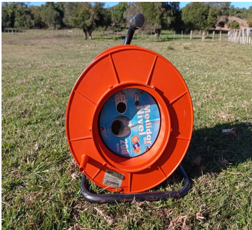
Figura 18 - Medidor de nível tipo fita
