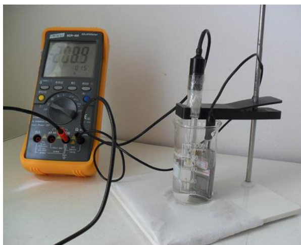
Figura 3.6 – Análise de medida de potencial de corrosão.
