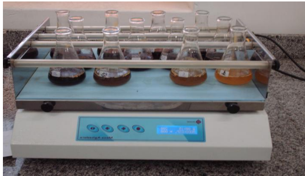
Figura 9. Representação do processo em batelada utilizado nos estudos de adsorção.
