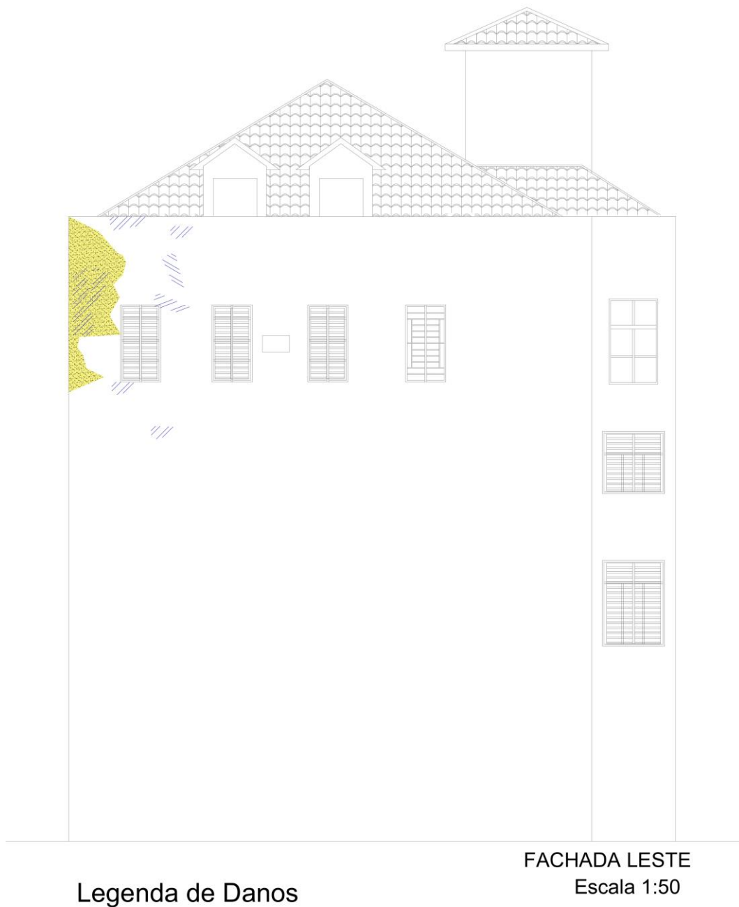
Figura 30 - Mapa de Danos do Edifício João Fontoura Borges (Fachada Leste)
