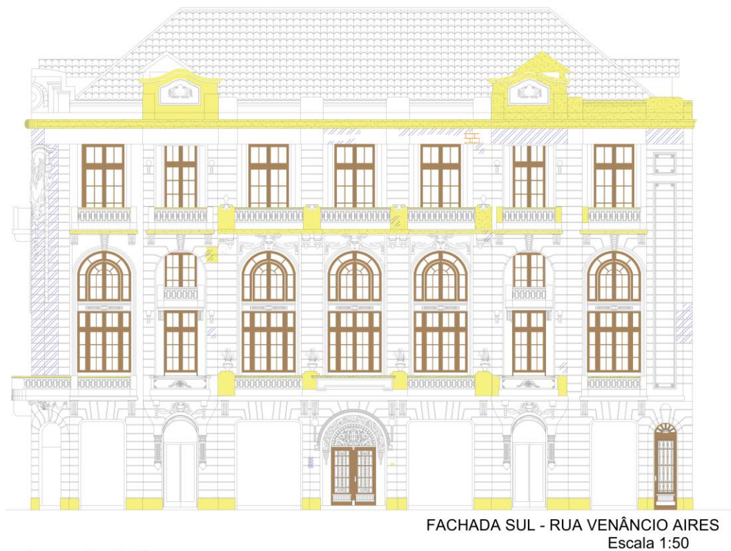
Figura 28 – Mapa de Danos do Edifício João Fontoura Borges (Fachada Sul)
