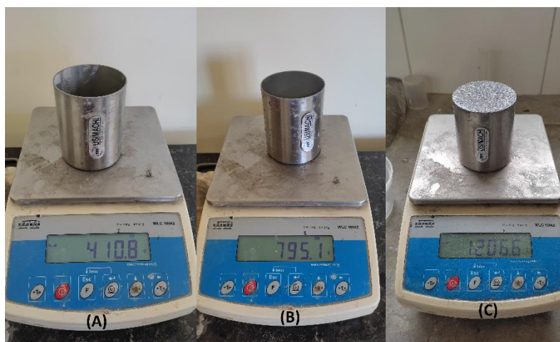
Figura 14 – Pesagem recipiente (a) vazio; (b) com água destilada; (c) com argamassa.
