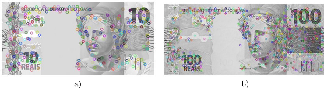
Figura 38 – Escolha do método de extração de pontos de interesse: (a) detecção de pontos de interesse com algoritmo SURF em cédula de 10 reais; (b) detecção de pontos de interesse com algoritmo SURF em cédula de 100 reais;
