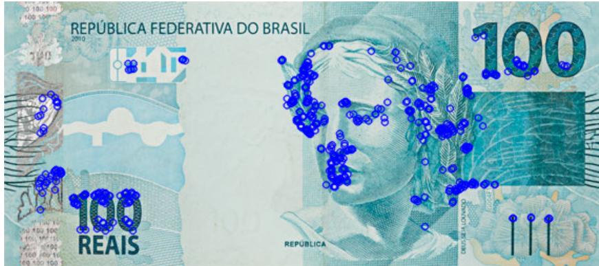
Figura 8 – Pontos de interesse extraídos em uma cédula de cem reais, usando o descritor ORB.
