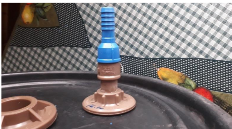
Figura 12 - Saída de gás do biodigestor
