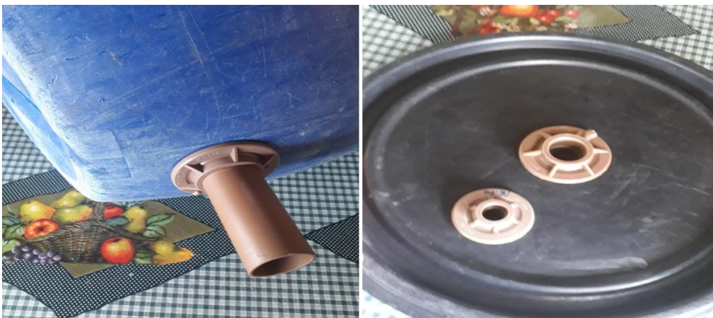
Figura 9 - Flanges acopladas a bombona
