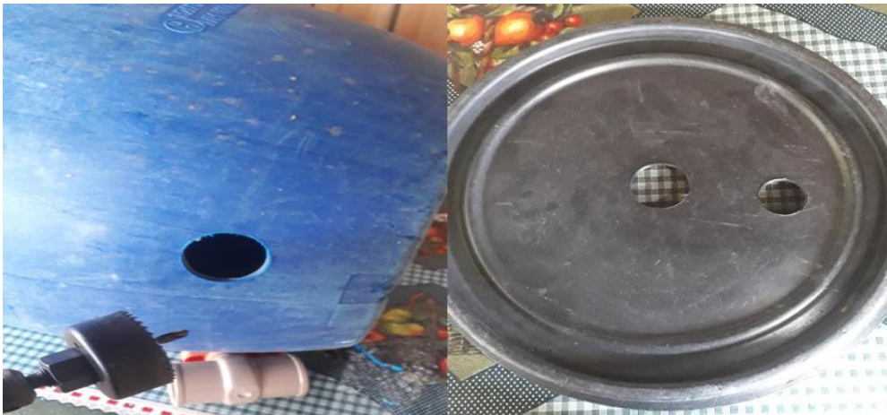
Figura 8 - Posições dos furos na bombona e tampa
