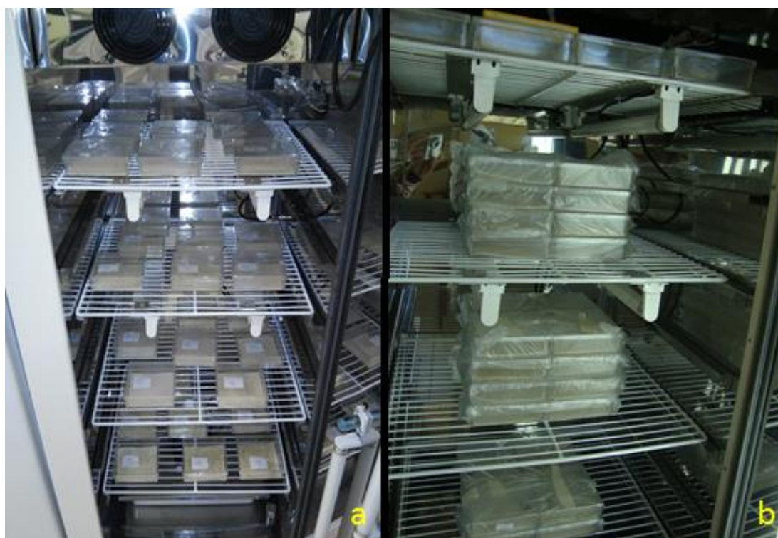
Figura 1 – Organização das caixas gerbox na câmara BOD, no primeiro experimento (a) e no segundo experimento, envoltas por plástico (b). Fonte: LORENSI.C.A.
