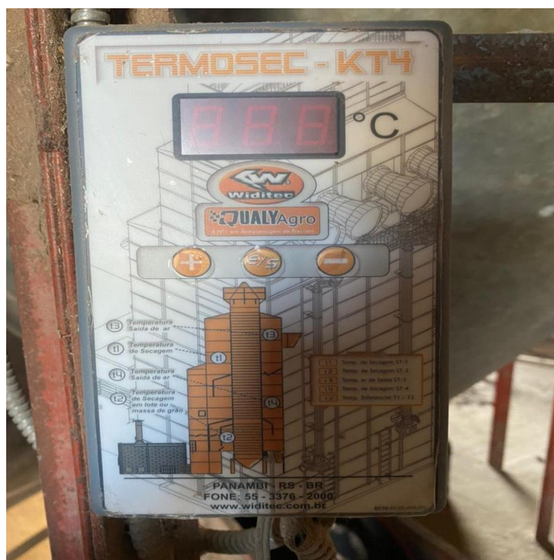
Figura 10 – Aparelho que indica a temperatura do ar que passa pela massa de grãos em uma unidade.
