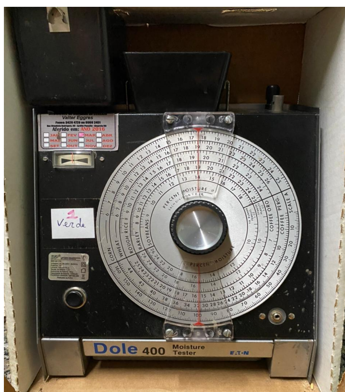
Figura 11 – Medidor de umidade por capacitância elétrica.
