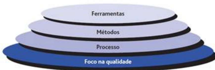
Figura 1 – Camadas da Engenharia de Software
