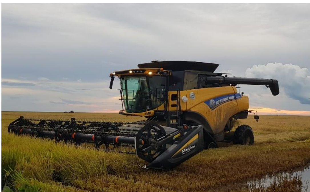
Figura 1 - Máquina utilizada para colheita de grãos de arroz irrigado
