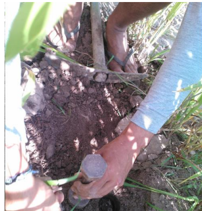
Figura 6. Coleta das amostras de densidade do solo
