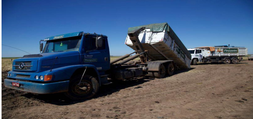
Figura 6: Caminhão com sistema Roll on/roll off . Fonte: VIZZOTTO, 2017.
