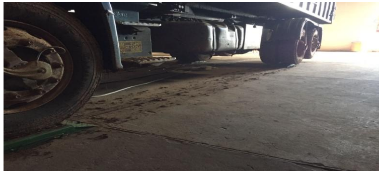
Figura 8: Pesagem com auxílio de balança móvel. Fonte: VIZZOTTO, 2017.
