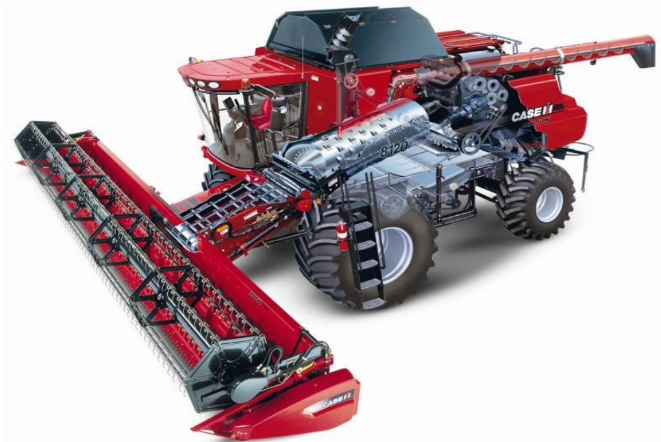
Figura 1. Colhedora equipada com sistema de trilha axial. Fonte: Sim Tractor (2011)
