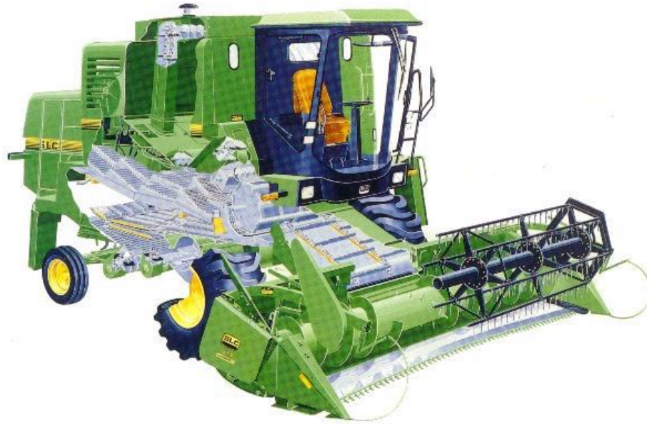
Figura 2. Colhedora equipada com sistema de trilha radial. Fonte: UFV (2011).
