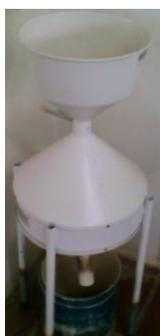
Figura 1: Homogeneizador tipo Boerner
