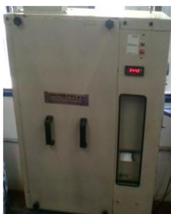
Figura 3: Separador de Impurezas.
