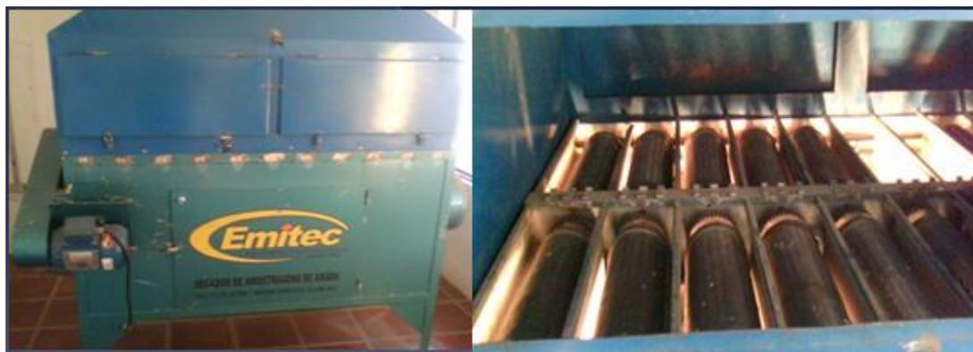
Figura 5: Secador de amostras rotativo
